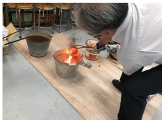
午後からは、2班に分かれて、「消失模型鋳物によるネームプレートの作製」と「電子レンジを活用したルビーの作製」を体験的に学びました。ネームプレートの作製では、発泡スチロールで模型を作製し、七輪にてアルミを溶解し、冷却することで完成しました。短時間で効率よく作業を進めることができるので、教材研究の新たな知見となりました。ルビーの作製では、電子レンジを用いることで視覚的に生徒が学べるものであると感じました。
